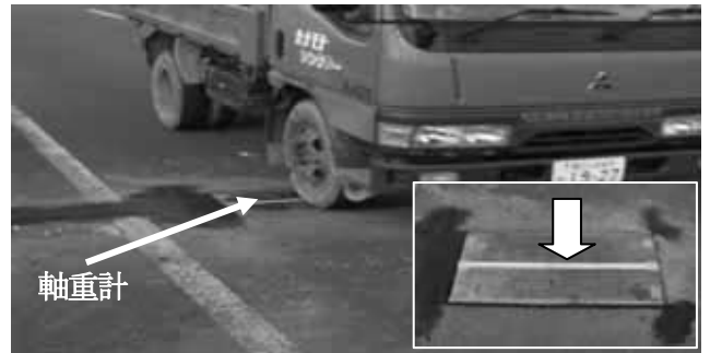
写真六 車両通過状況とセンサ設置状況
