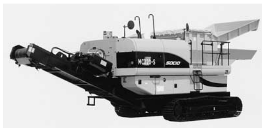
写真-4 新キャタピラー三菱「SOCIO」MC220-S 自走式破砕機
