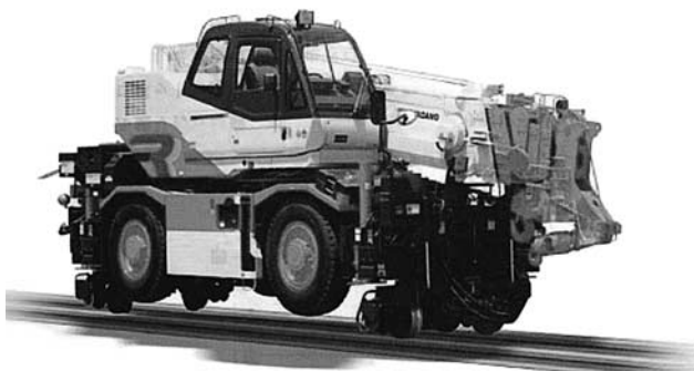
写真一 2 タダノ GR-180N ラフテレーンクレーン (軌陸仕様車)
