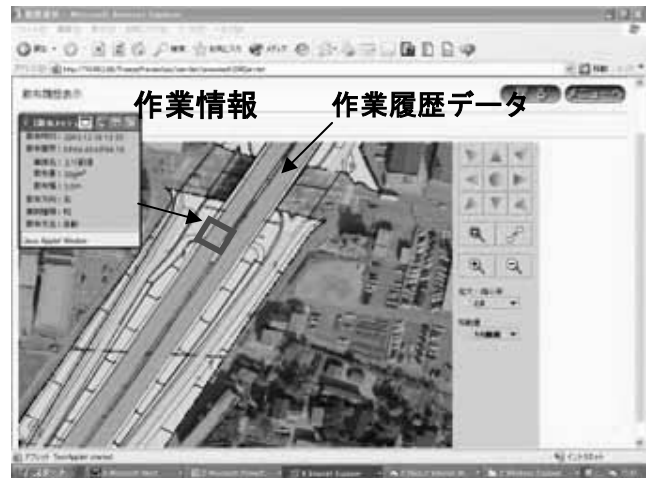
図一3 GISを利用した作業履歴確認画面
