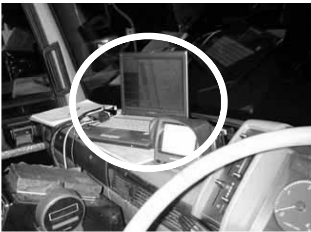
図一五 散布車に搭載されたノートPC
