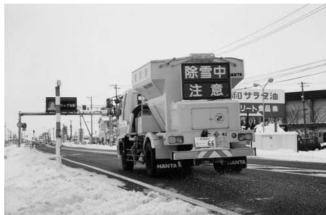
図一 1 凍結防止剤散布車による作業状況
