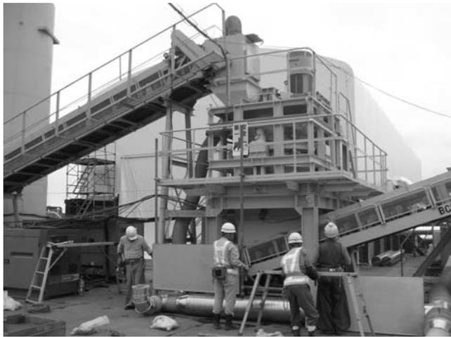
写真-1 回転式破碎混合装置概観
