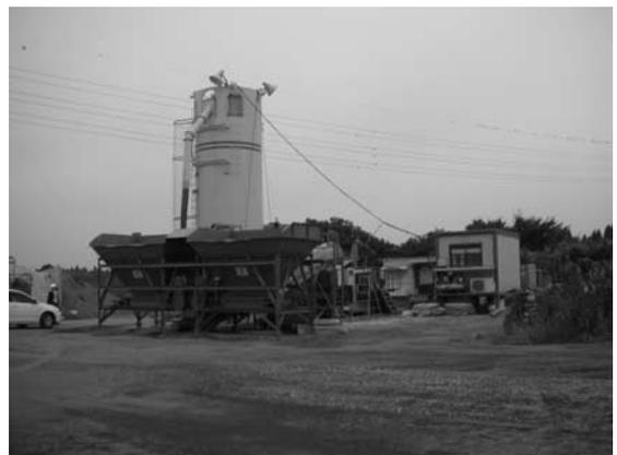
写真—1 定置型フォームドアスファルトプラント(骨材フィーダ側から望む)
