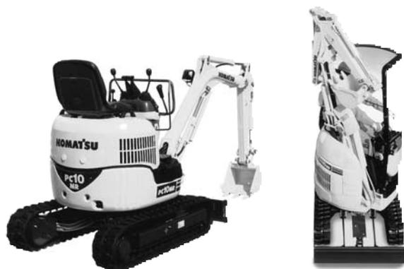
写真一 コマツ PC10MR-2 (左) と PC10UU-5 (右) ミニショベル
