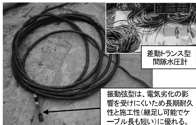
写真一二十一 振動弦型間隙水圧計、真綿川ダム
