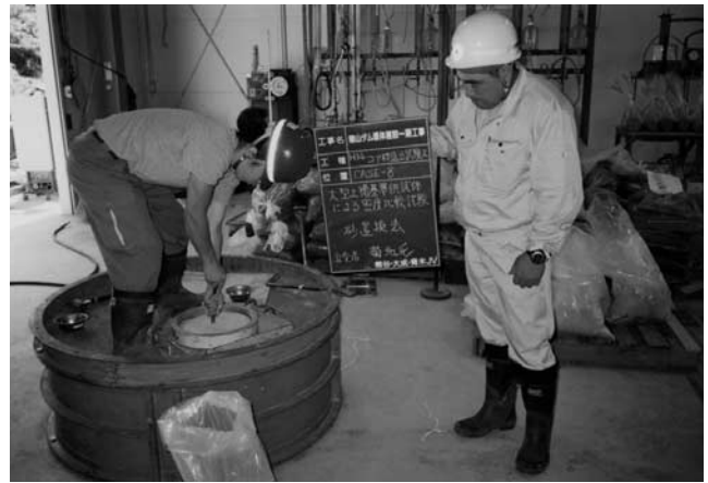
写真—6 砂置換法による現場密度試験
