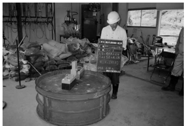
写真—8 自動走査式(SRID)RIによる現場密度試験
