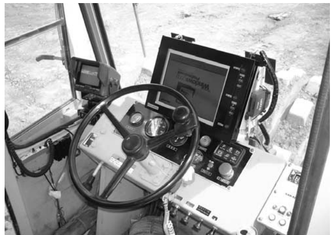
写真一 11 転圧機の車載用モニター
