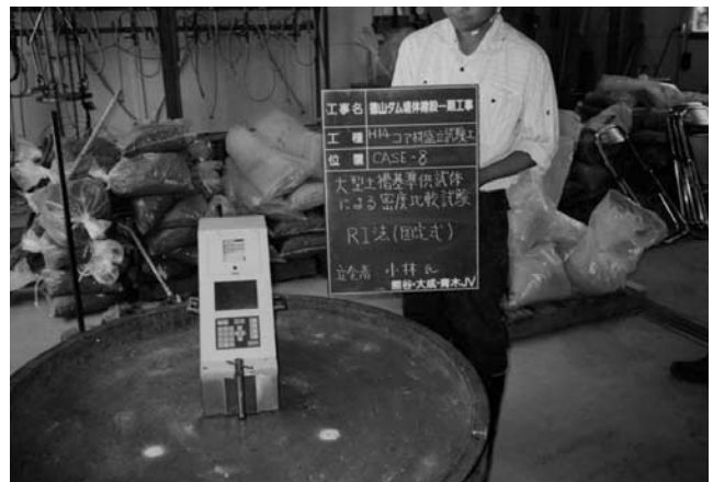
写真—7 固定式RIによる現場密度試験
