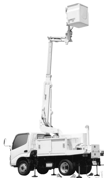
写真二 アイチコーポレーション「スカイマスター」SE08C 高所作業車
