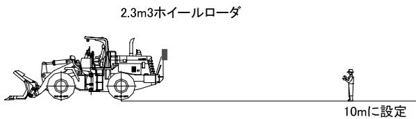
図-4 アンテナ取付位置および検知距離
