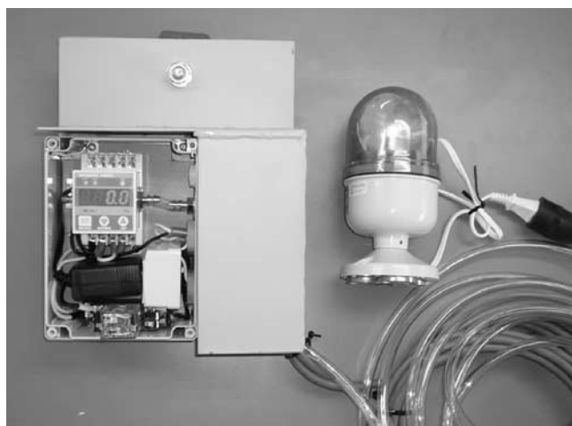
写真-4 負圧管理システム機器
