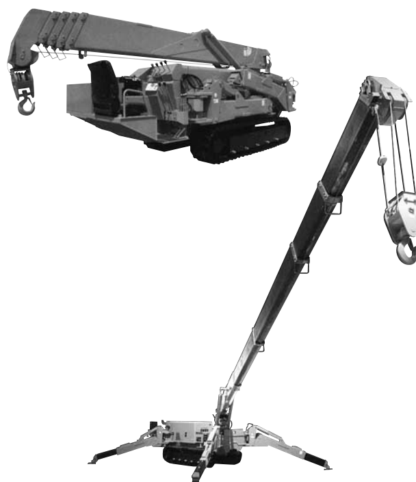
写真-4a, 4b 前田製作所「かにクレーン」MC-405C クローラクレーン
