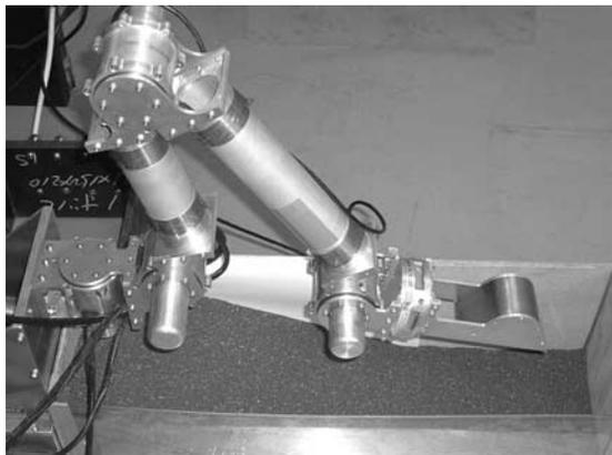
図一七 知能化パワーショベル模型による掘削実験
