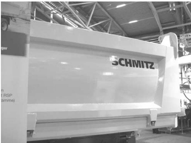
写真一29 テールゲートパネルロール成形
