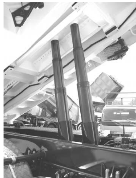
写真—37 2本シリンダの3転ダンプ
