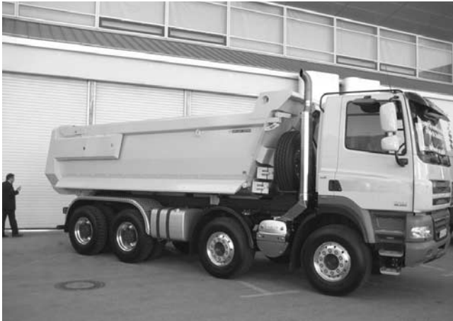
写真一28 パネル紐だしスチフナレス (テールゲートはシリンダにて持ち上げる)
