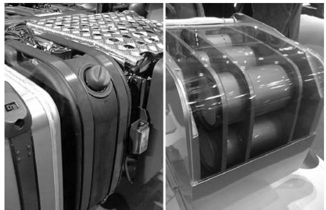
写真—22 AdBlueのタンクとSCRカットモデル
