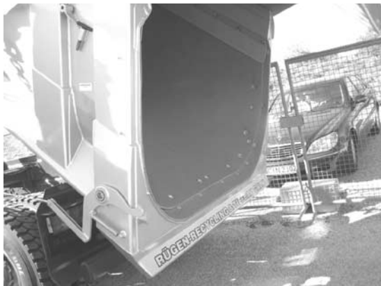
写真—34 ハーフパイプ（内法にライナー取付）
