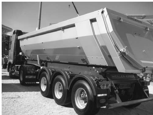
写真—26 ハーフパイプ（ヒンジ部にのみスチフナが付く）
