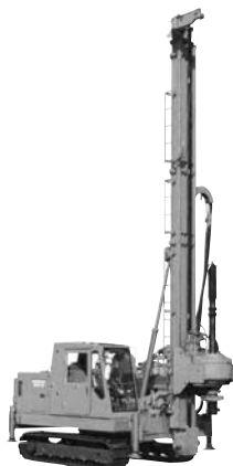
写真-6 日本車両製造 DH358-90M (左), DHJ-15 (右) パイルドライバ
