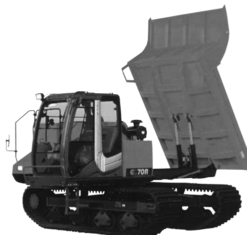
写真一 5 日立建機 EG70R-3 不整地運搬車 (全旋回式)
