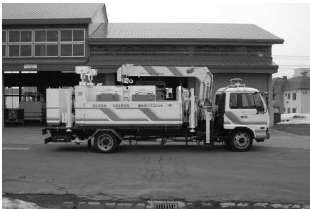
写真一七 排水ポンプユニット搭載
