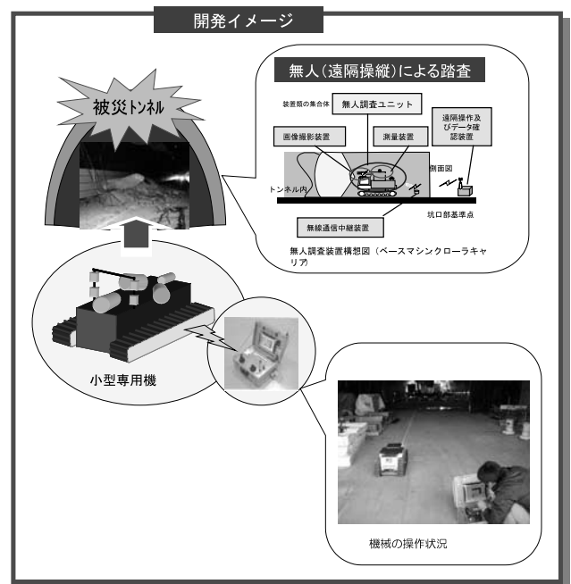
図一 二 トンネル臨時点検の無人調査車
