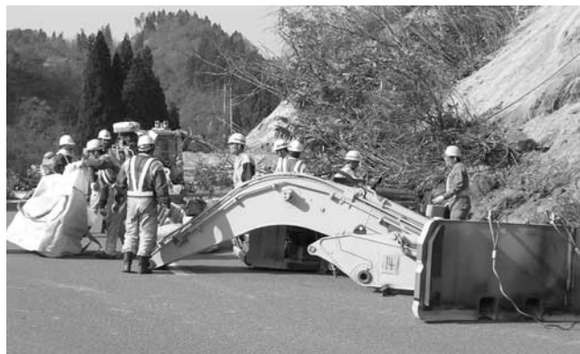
写真—3 ヘリコプターで空輸するために分解したバックホウ
