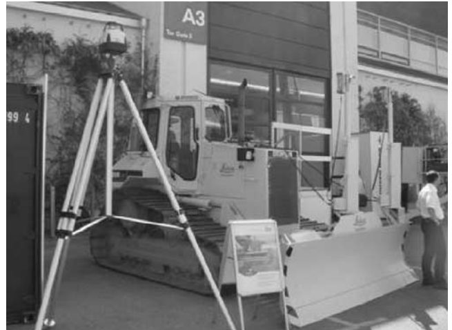
写真-57 屋外ブース CATERPILLAR ドーザ 2D システム
