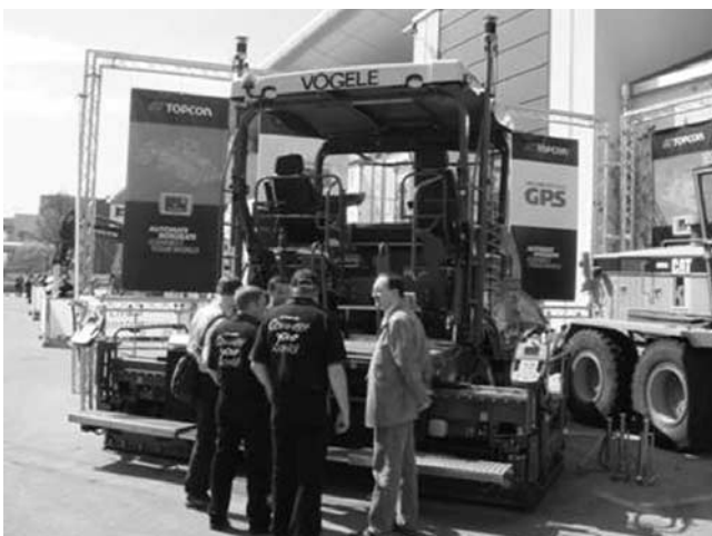
写真—51 フィニッシャー mmGPSシステム搭載
