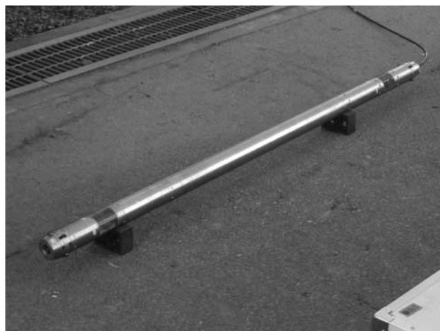
写真-1 挿入式ジャイロ計測器
