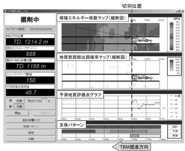
図-2 TBM のモニター画面
