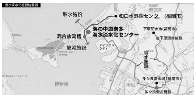
図—2 まみずピアの位置および送水経路 1)
