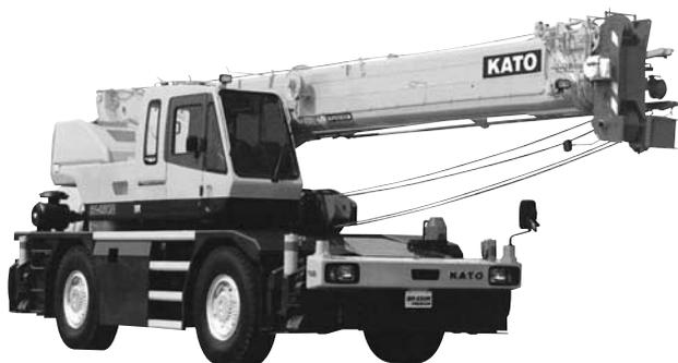
写真一七 加藤製作所 SR-250R PREMIUM ラフテレーンクレーン
