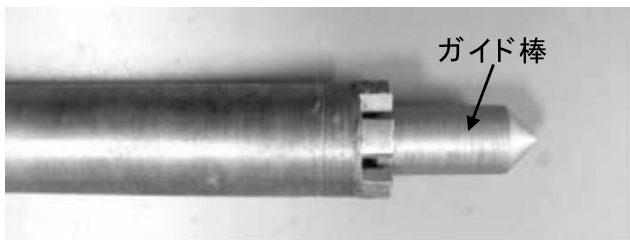
写真一 4 ガイド棒付ダイヤモンドコアビット
