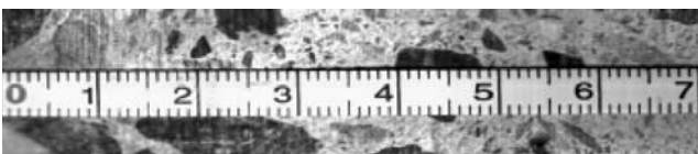
写真-3 孔内にスケールを貼付したスキャニング画像
