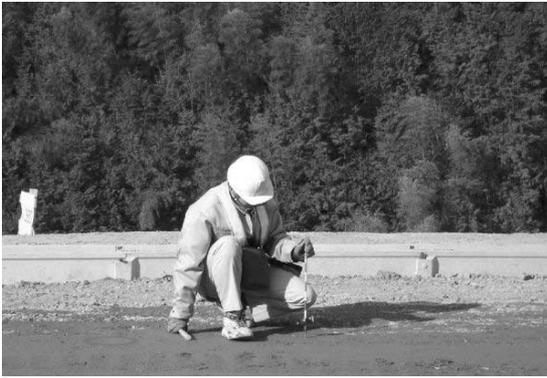
写真—4 測定時のミラー設置状況
