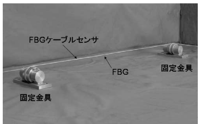
写真—3 FBG ケーブルセンサ
