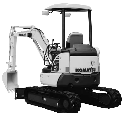
写真一 2-1 コマツ「GALEO」PC30MR-3 ミニショベル（後方超小施回り形）
