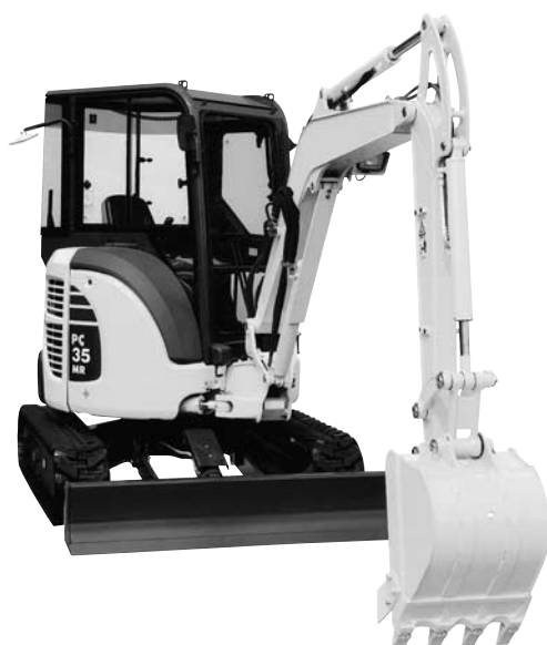
写真一 2-2 コマツ「GALEO」PC35MR-3 ミニショベル（後方超小施回り形）
