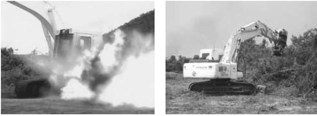
爆風型地雷 OZM2 による爆破試験状況 完成し伐採作業を実施している 16t 級地雷除去機
