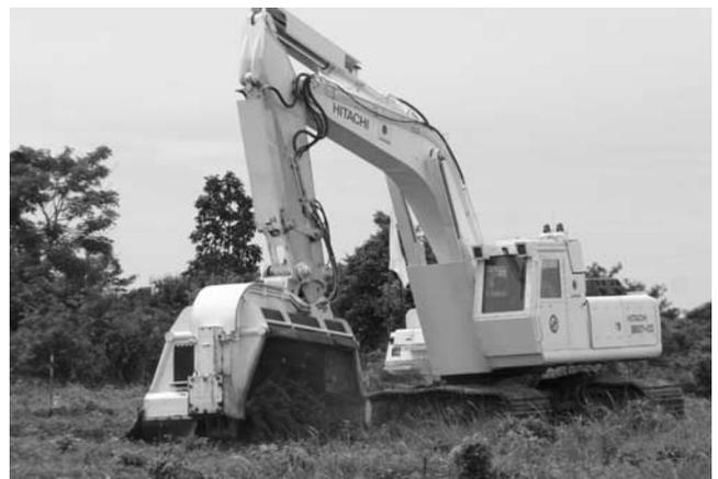
写真一 4 30t 級旋回型フレール式除去機
