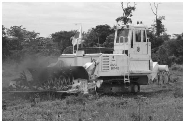
写真—5 自走型フレールハンマー式除去機
