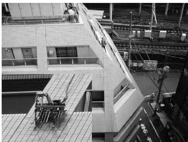
写真—2 斜壁におけるロボット診断
