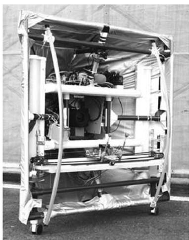
写真—3 タイル診断ロボットの概観
