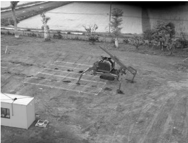
写真-8 平地での模擬フレーム跨ぎ越え実験
