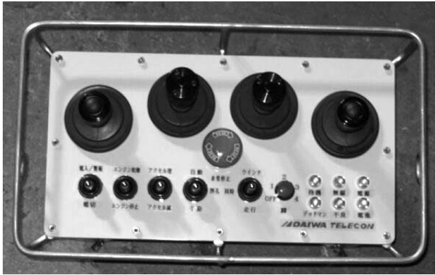
写真一六 無線コントローラ
