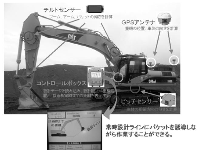
図—5 バックホウ誘導システム
