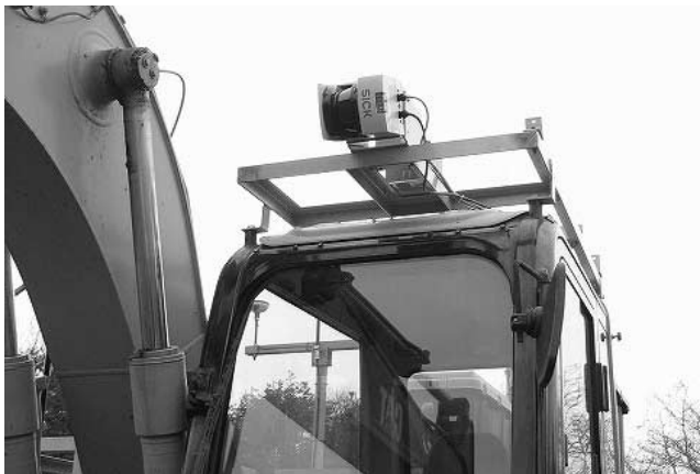
写真—2 レーザスキャナ・システム
