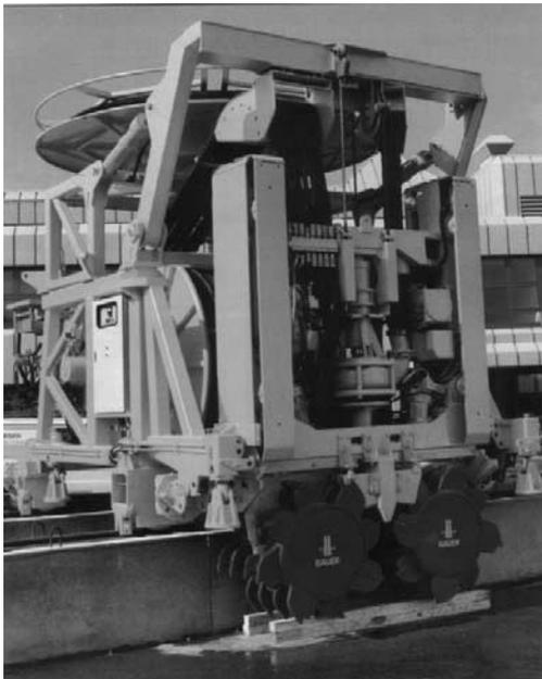
写真—1 水平多軸回転式カッター
