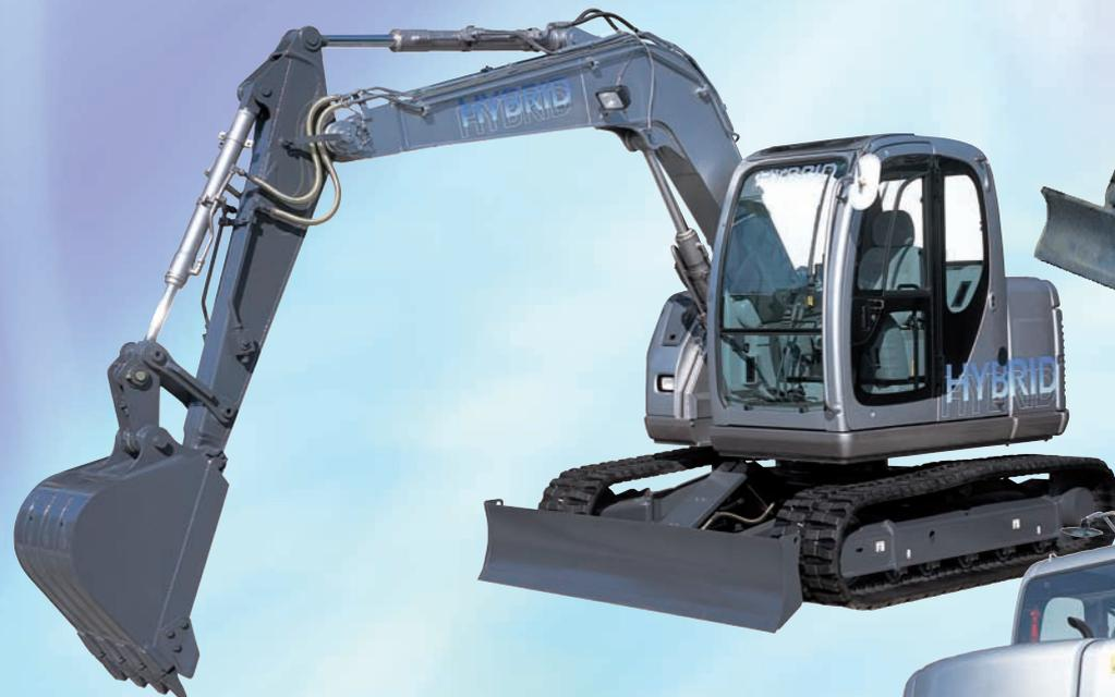
⇄6トンクラスのハイブリッドショベル。エンジン出力を発電機により電力に変換し、ブーム・アーム・バケットを油圧ポンプと電動モーターで駆動、上部旋回を電動モーターで直接駆動するシリーズ型ハイブリッドを採用。バッテリーからのパワーアシスト、エネルギー回生などで40%燃費を低減。(発売前)
