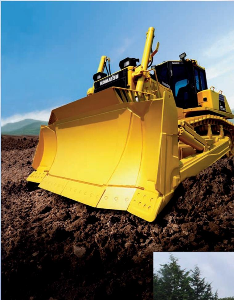
⇨これまでとは異なる形状の新型ブレードを搭載（シグマドーザ）したブルドーザ。ブレード中央部に張り出し部位を設け、車体の推進力を集中させると共に掘削抵抗を低減。また、ブレード後方への膨らみで掘削土砂を抱え込み側方への土砂こぼれを低減。ロックアップ付き自動変速パワーラインと合わせ、メーカー内比較で燃費効率を25%向上。（発売中）
