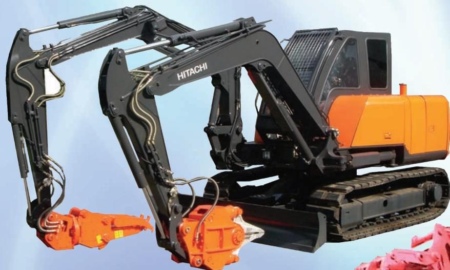
↔↕2本の腕を持つ双腕ショベル。1本のレバーで6自由度のフロント部を操作し、挿んで切るなどの協調動作も可能。旋回、走行を含め16自由度を持つが、直感的な操作で短時間での習熟可能。(発売前)
