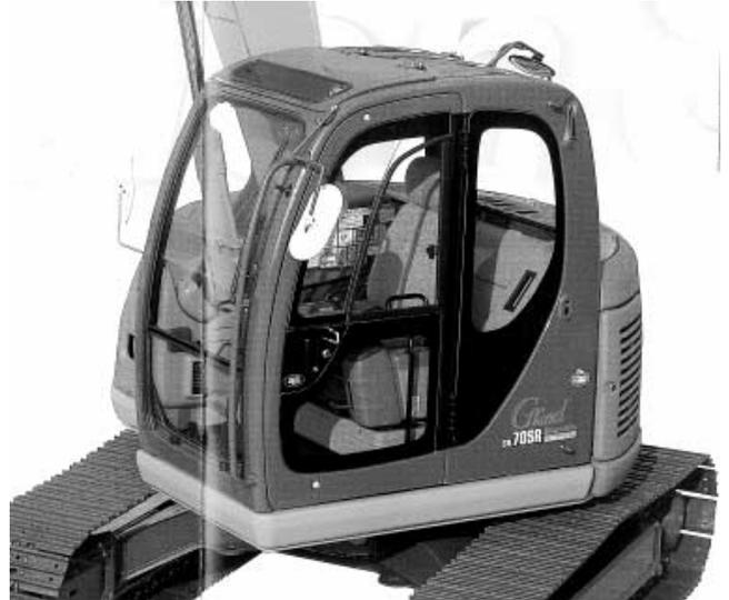
写真一6 小・中型後方超小旋回機のキャブ
