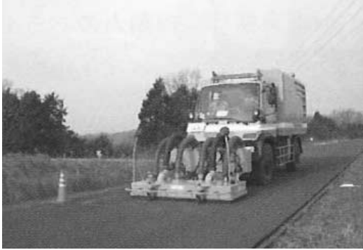
図一七 低騒音舗装の機能維持装置
