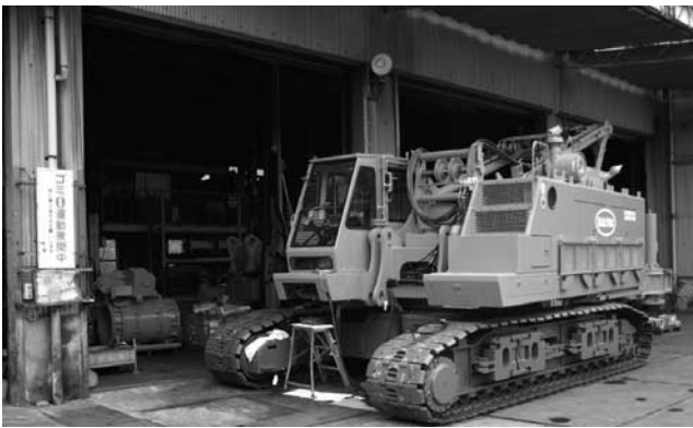
写真一八 特殊改造組立中の杭打機
