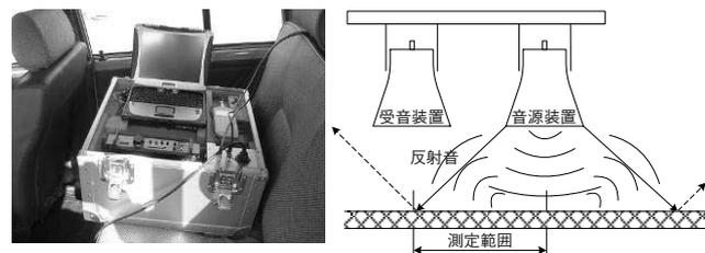
図一3 車内設置状況（左）とシステムの測定範囲（右）
