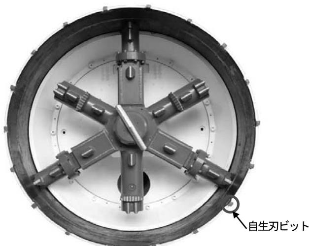
写真一1 MELIT 工法掘進機 (正面)
