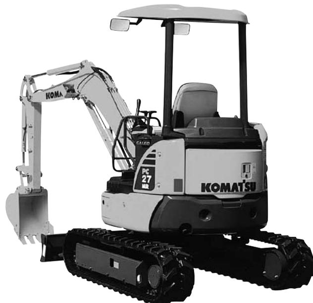
写真—3 コマツ「GALEO」PC27MR-3 ミニショベル (後方超小旋回形)
