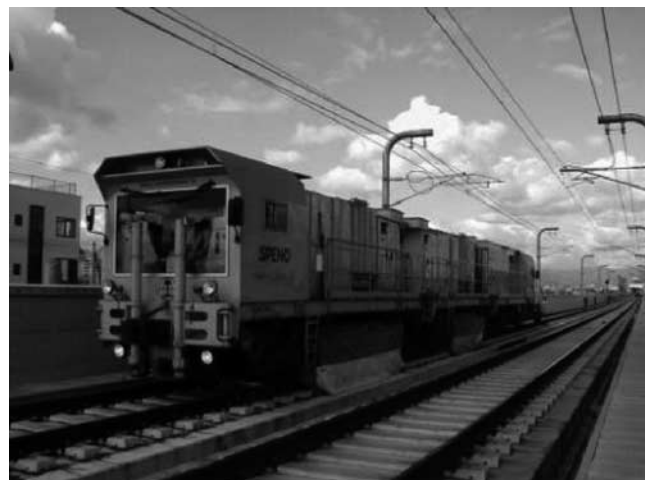
写真—2 レール削正車
