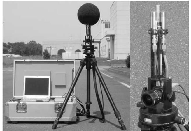
写真-1 音源探査装置の概観 (左) およびマイクロホン部 (右)
