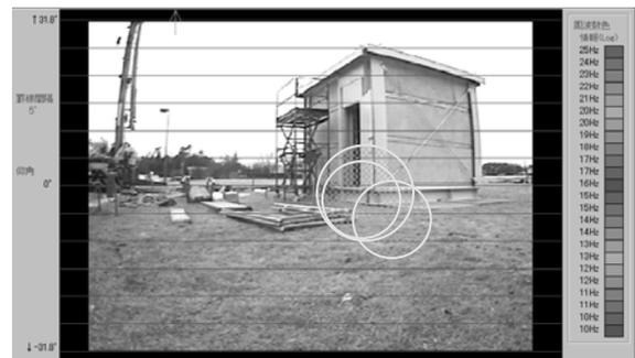
図一 19 防音建屋の音源方向の表示 (20 Hz 正弦波)
