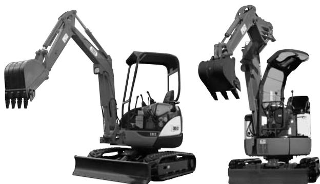
写真—5 石川島建機 30VX ミニショベル (後方超小旋回形) (左) と 20VZ (超小旋回形) (右)
