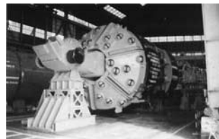
写真—3 リーミング TBM
