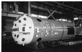
写真—2 パイロット TBM
