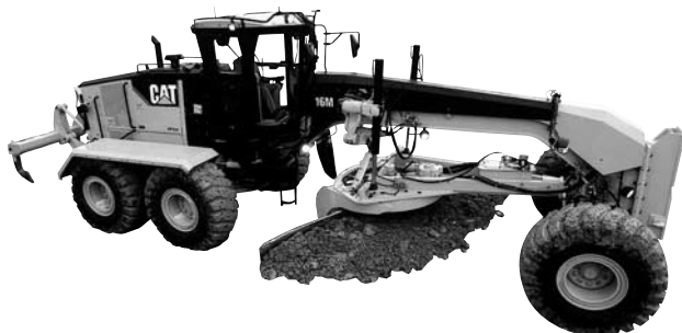
写真一七 新キャタピラー三菱 CAT 16M モータグレーダ
