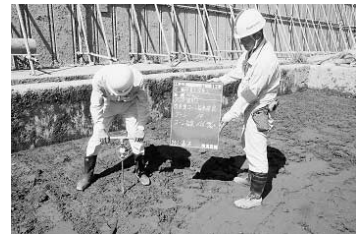
写真十一 改良後コーン指数確認状況
