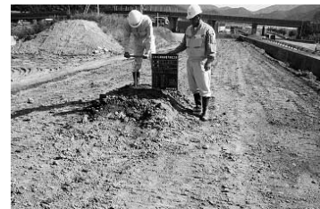
写真十四 現場 3 日強度 コーン指数確認状況
