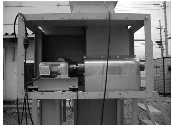
写真—7 短繊維計量装置近景
