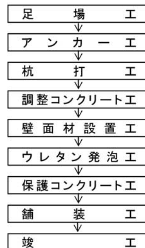
図-2 施工フロー
