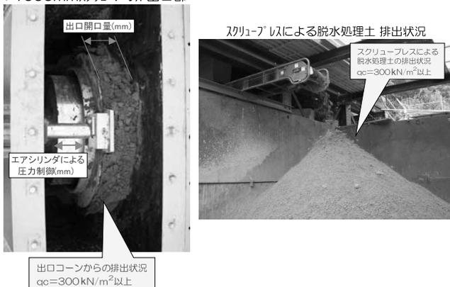
写真-8 脱水処理土の状況 (コーン指数: 300 kN/m<sup>2</sup> 以上)
