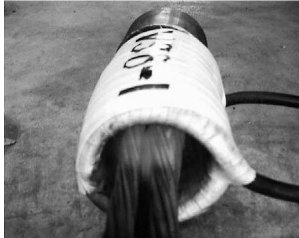
写真—1 PC 鋼線加熱状況
