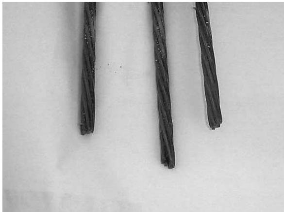
写真一六 PC鋼線切断状況
