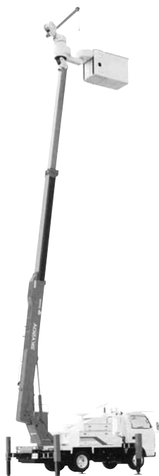
写真-3 タダノ「スカイボーイ」AT-147CE 高所作業車
