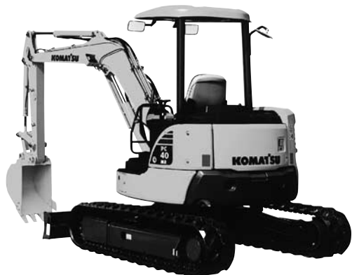
写真一 2 コマツ PC40MR-3 ミニショベル (後方超小旋回形)
