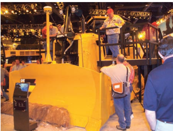
⇧ CAT D7E 電気駆動ブルドーザ
