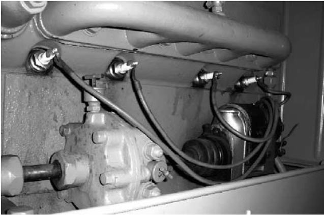
写真-5 エンジン左側の点火系統部品
